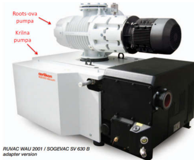
Slika 3: Vakum sistem koji se sastoji od krilne i Roots-ove pumpe.
